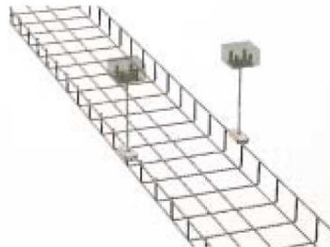
U slučaju isječenja bočnih pruta žljeba, odn. kod drukčijeg od preporučenog razvrstavanja podupirača je potrebno uvažavati promjenu statičkog djelovanja i time odjednom smanjenje nosivosti pojedinih žljebova.
