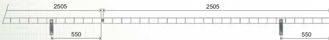
**U slučaju isječenja bočnih pruta žleba, odn. kod drukčijeg od preporučenog razvrstavanja podupirača je potrebno uvažavati promjenu statickog djelovanja i time odjednom smanjenje nosivosti pojedinih žlebova.**
